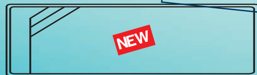
COULOIR DE NAGE L 11,00 m x l 3,00 m Prof. 1,50 m Fond plat
